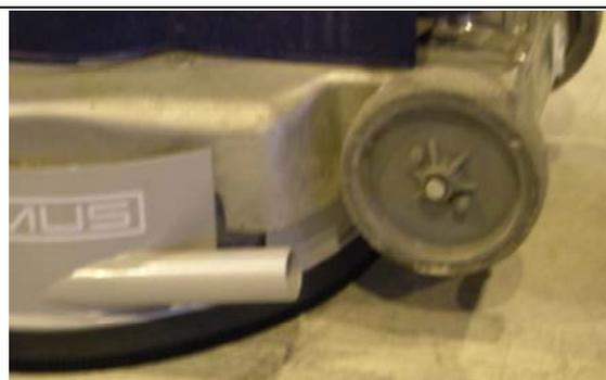
Connecter le tuyau de l'aspirateur sur la sortie d'aspiration.
